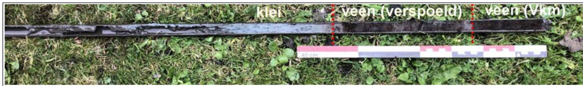
Figuur 15. Sneek, Het Eiland: Boring 24 met het opgeboorde sediment. De onderkant van de guts (rechts) reikte tot circa 200 centimeter beneden maaiveld. De bodem bestaat op deze diepte uit veen met hierop een verspoelde veenlaag en klei.
