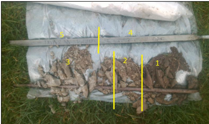
Afbeelding 15. Foto van boring 25 met van onder naar boven: 1) bouwvoor; 2) geploegde laag; 3) natuurlijke klei, zandig, met roestvlekken; 4) natuurlijke klei, siltig, met zandlagen en roestvlekken; 5) siltige klei met zandlagen en humusvlekken
