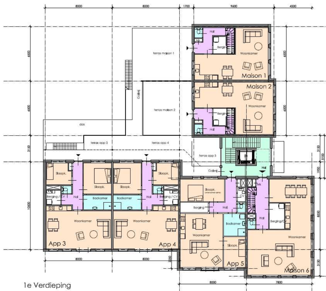
Figuur 4: Indeling 1 e en 2 e verdieping
