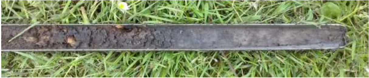
Figuur 11: Foto van de doorwortelde en zwak venige top van het dekzand zoals deze in veruit de meeste boringen is aangetroffen..
