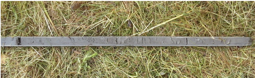
Figuur 5. Sneek, Furmerusstraat. Foto van de door zandlaagjes onderbroken klei zoals deze onderin alle boringen is aangetroffen.
