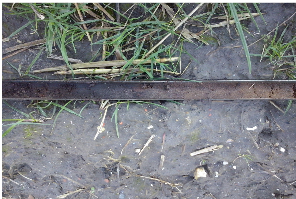
Figuur 6. Ferwoude, Buren 24a. Foto van boring 11 met het onder het veen aangetroffen dekzand.
