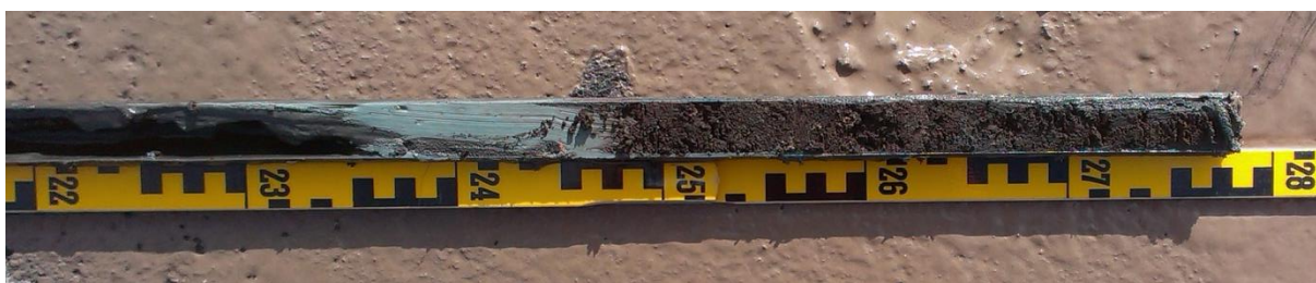
Afbeelding 6. Een foto van de boorkern van boring 10. De blauwe klei en de onderliggende veenlaag behoren tot de natuurlijke ondergrond van het gebied (zie voor locatie bijlage 2)
