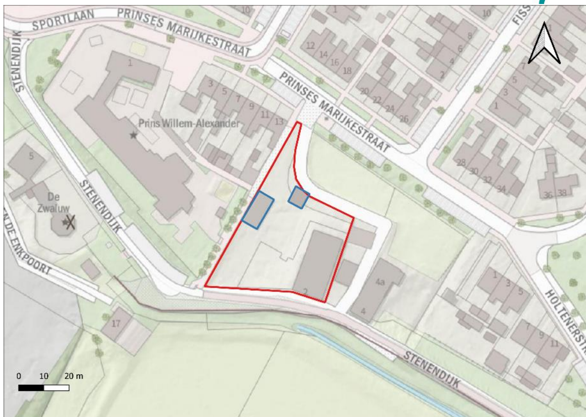
Figuur 1.1 Plangebied (rood omlijnd), waarbij de werkzaamheden zich beperken tot de twee bijgebouwen (blauw omlijnd). Het rechter bijgebouw (schuur/carport) wordt gesloopt en elders op het perceel opnieuw gebouwd, het linker bijgebouw zal worden uitgebreid naar volwaardige woning (bron achtergrondkaart: ArcGIS).
