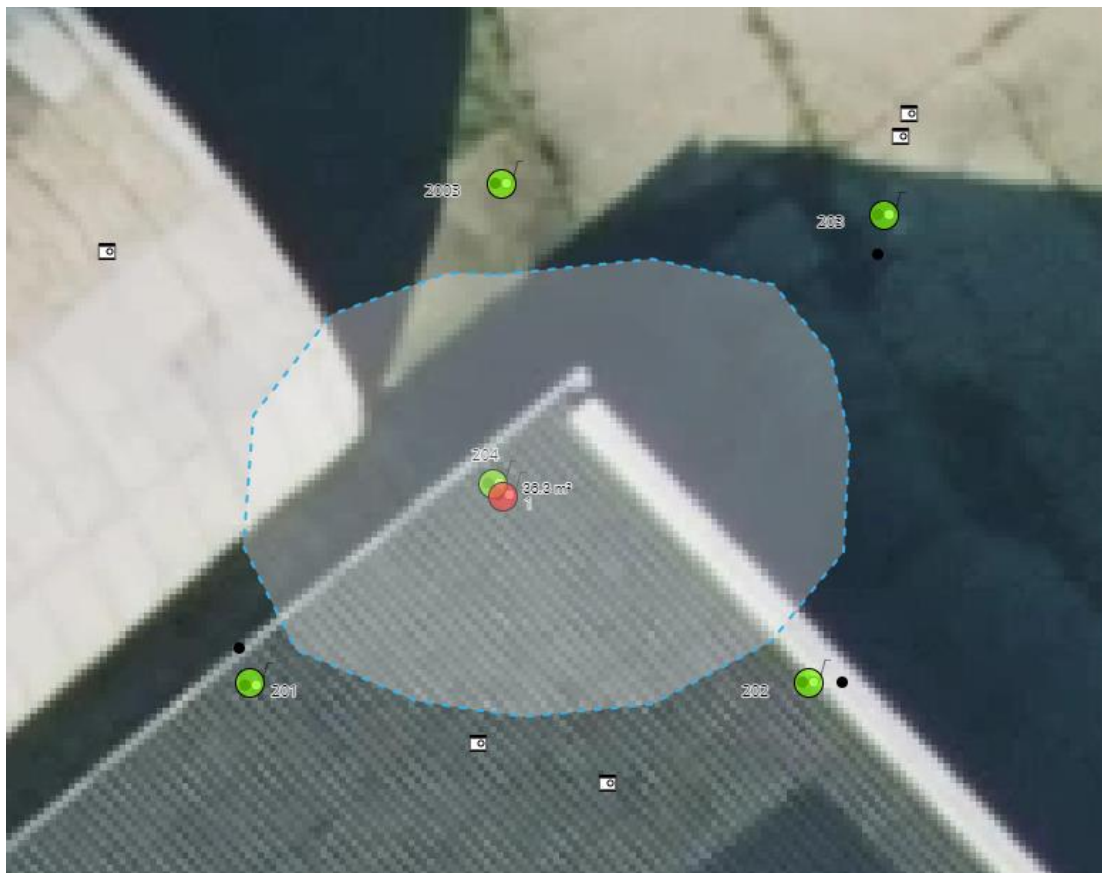
Figuur 6.2 Overzicht sterke minerale olie verontreiniging in het grondwater ter plaatse de voormalige vacuümpomp.
