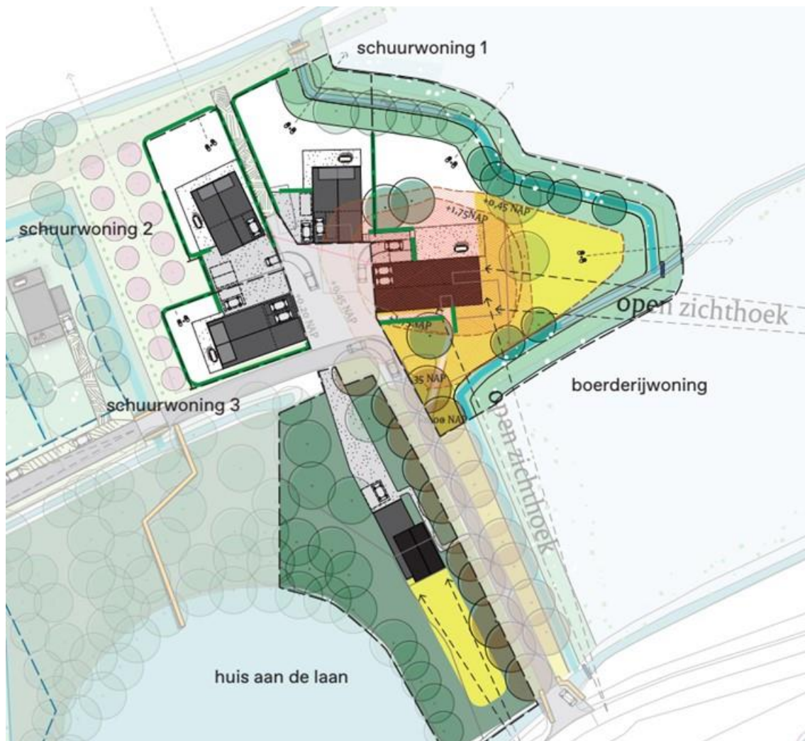
afbeelding 24: Uitsnede Beeldkwaliteitsplan met daarin meer concreet de nieuwe inrichting van de terp en het bebouwingsensemble (bron: Van Paridon x De Groot)
