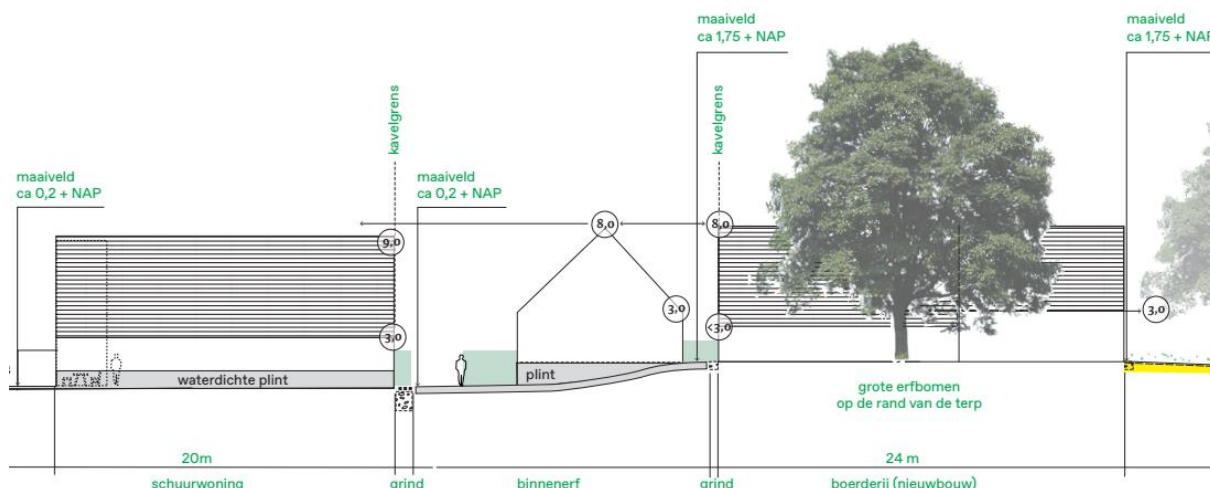
afbeelding 26: doorsnede bebouwing op de terp met de goot- en nokhoogtes aangeduid t.o.v. het maaienveld (bron: Van Paridon x De Groot)
