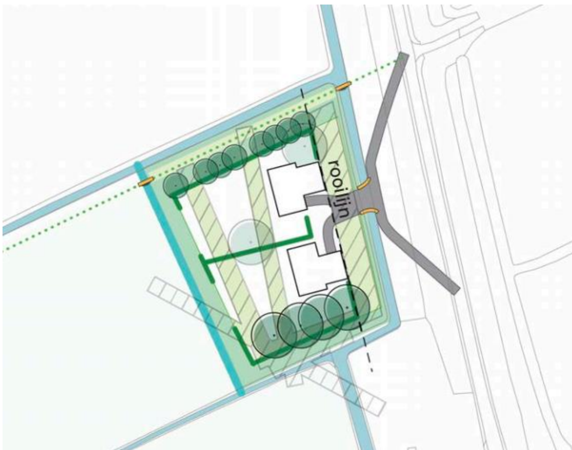
afbeelding 29: inrichting kavels en rooilijn dijkwoningen in het BKP (bron: Van Paridon x De Groot)
