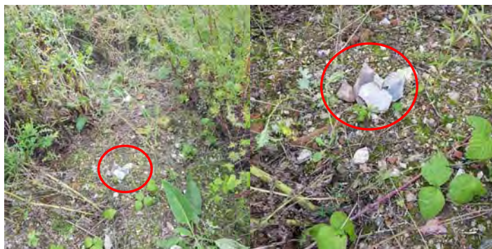
Asbestverdacht materiaal aan maaiveld ter plaatse van puinlaag
