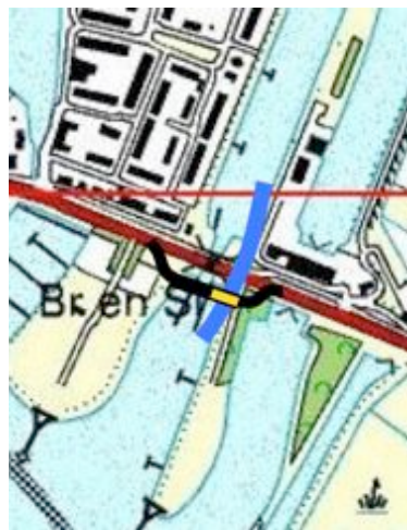
Figuur 4: Schematische voorstelling laterale kanaal en tijdelijke brug.
