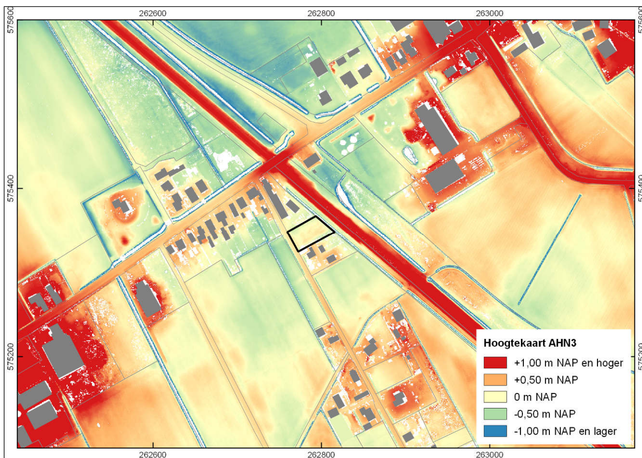
Figuur 3: Detailopname van de maaiveldhoogte (AHN3). Het plangebied aan de Tranendallaan is aangegeven met een zwart kader. In het plangebied komen amper hoogteverschillen voor.
