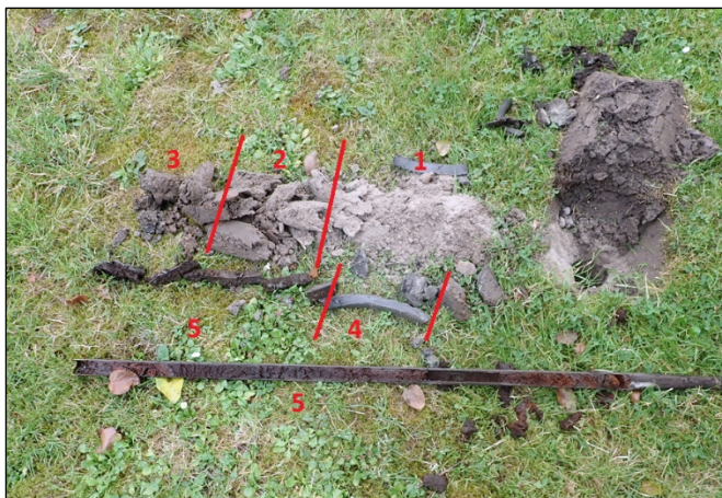
Afbeelding 7. Foto van boring 1, met interpretatie. 1: opgebrachte grond, 2: zwak zandige klei, 3: klei met verslagen veen, 4: sterk zandige klei, 5: veen
