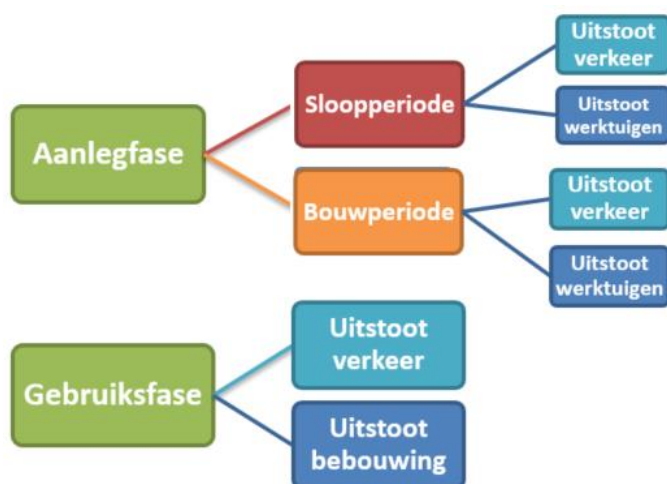
Afbeelding 4: Indeling aanlegfase en gebruiksfase
