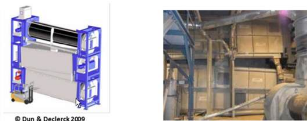
Figuur 2.4: verwerking van hennepstro door middel van zeeftrommels.
