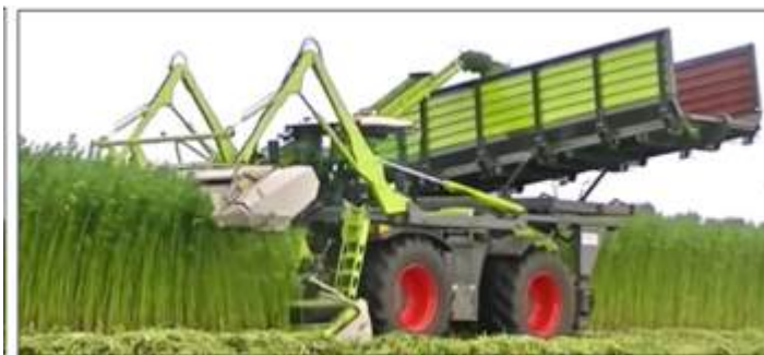
Figuur 2.1: oogst van industriële hennep met een Xerion 4000 (ontwikkeld door Dun Agro b.v.)
