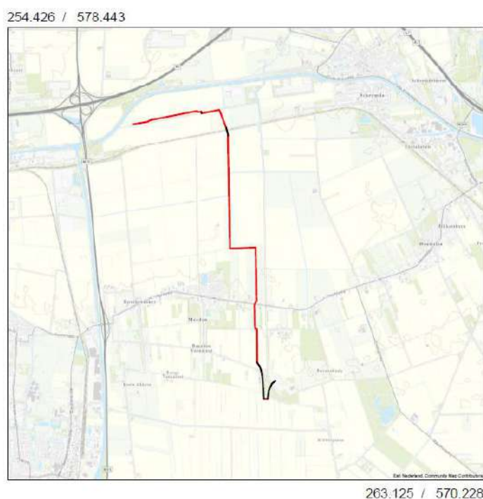
Afbeelding 1. Uitsnede van de topografische kaart waarop het onderzoeksgebied met rode en zwarte lijnen is aangegeven. Rood: open ontgraving, zwart: gestuurde boring (bron: Esri Nederland en gegevens opdrachtgever)
