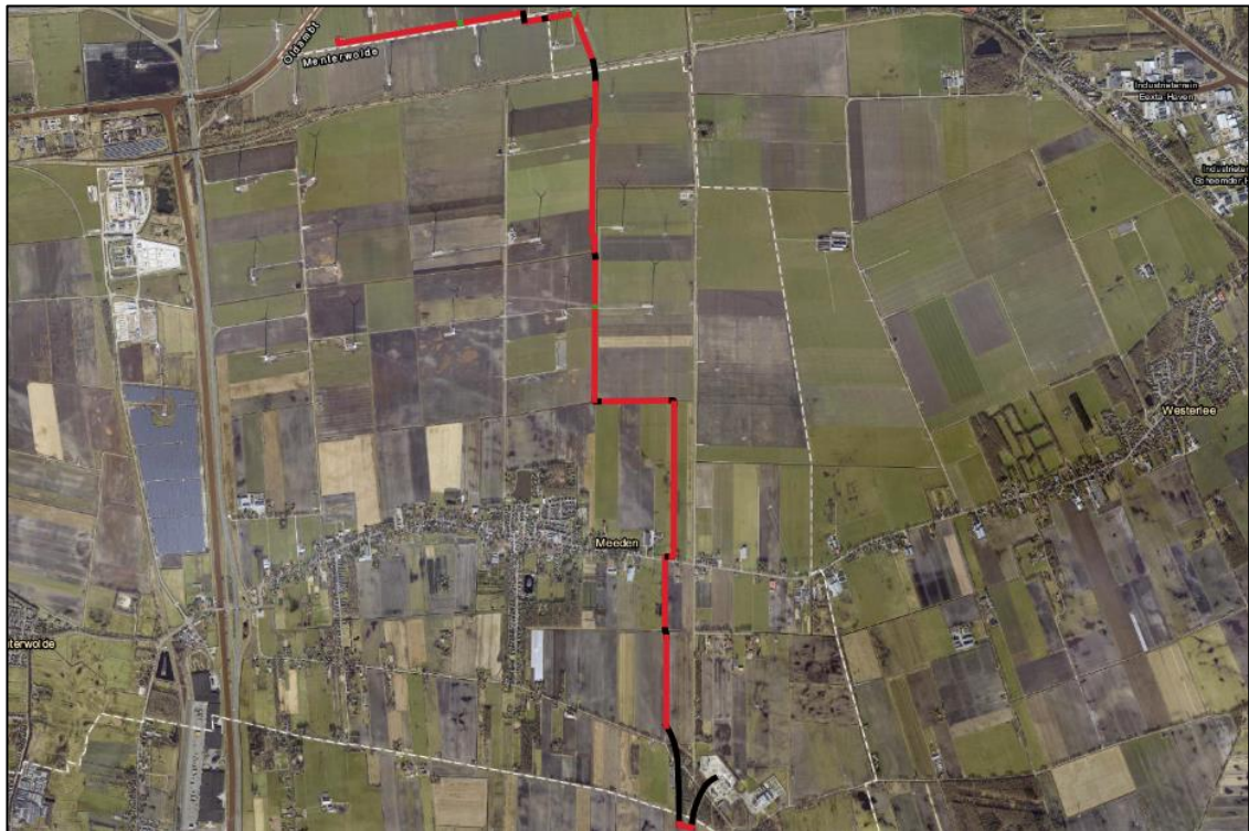
Afbeelding 2.1. Ligging van het tracé nabij Meeden (rood = open ontgraving, zwart = HDD, groen = persing) (bron achtergrond: Esri).
