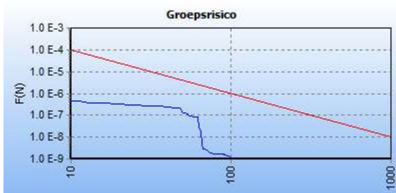
Afbeelding 5 fN-curve buisleiding A-520-01-deel-1, huidige situatie
