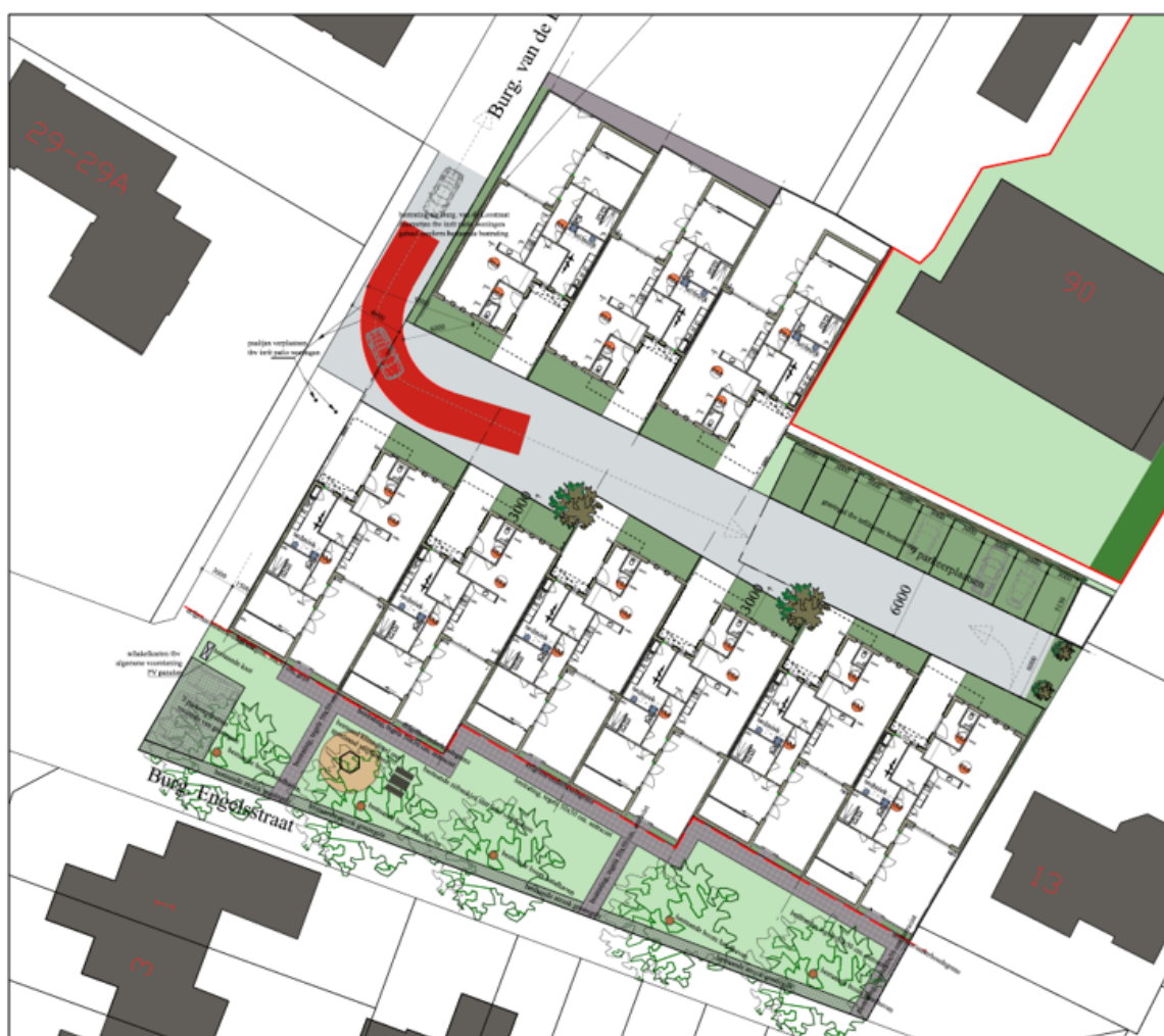
Figuur 11. Plattegrond planontwikkeling met weergave benodigde draaicirkels (in rood) voor vrachtauto's.
