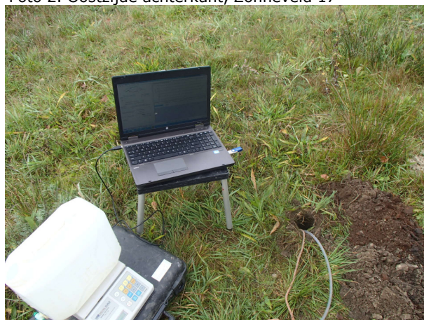
Foto 4. Infiltratieopstelling van INF 01
