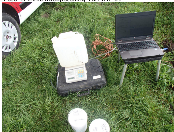
Foto 6. Infiltratieopstelling van INF 02
