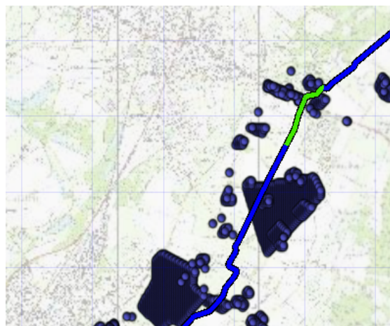
Figuur 76: FN curve van de kilometer met de hoogste overschrijdingsfactor (0.20) van de A-665-155 t/m 175 (stationing 75.0-87.5 km). De ligging van de kilometer met de hoogste overschrijdingsfactor is hiernaast in het groen weergegeven op een topografische kaart.
