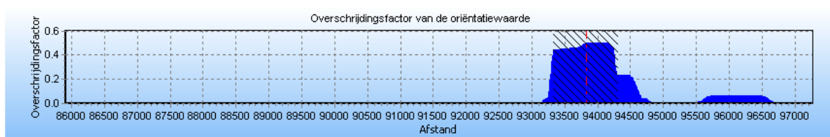
Figuur 77: Groepsrisicoscreening A-665-172 t/m 190 (stationing 85.9-97.3 km). De kilometer met de hoogste overschrijdingsfactor is gearceerd weergegeven.
