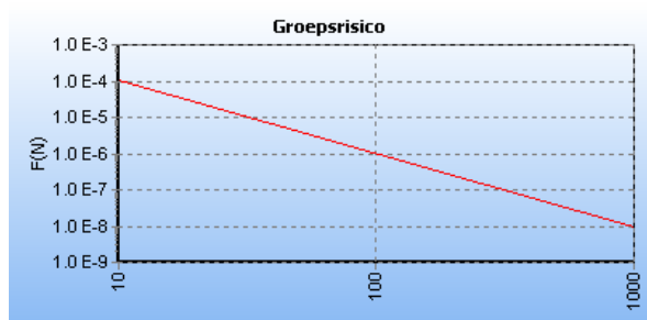
Figuur 62: FN curve van de kilometer met de hoogste overschrijdingsfactor (0.00) van de A-665-050 t/m 067 (stationing 11.1-21.4 km). De ligging van de kilometer met de hoogste overschrijdingsfactor is hiernaast in het groen weergegeven op een topografische kaart.
