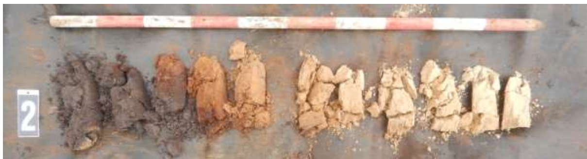
Figuur 16: Foto van boring 2, uitgelegd van links naar rechts.
