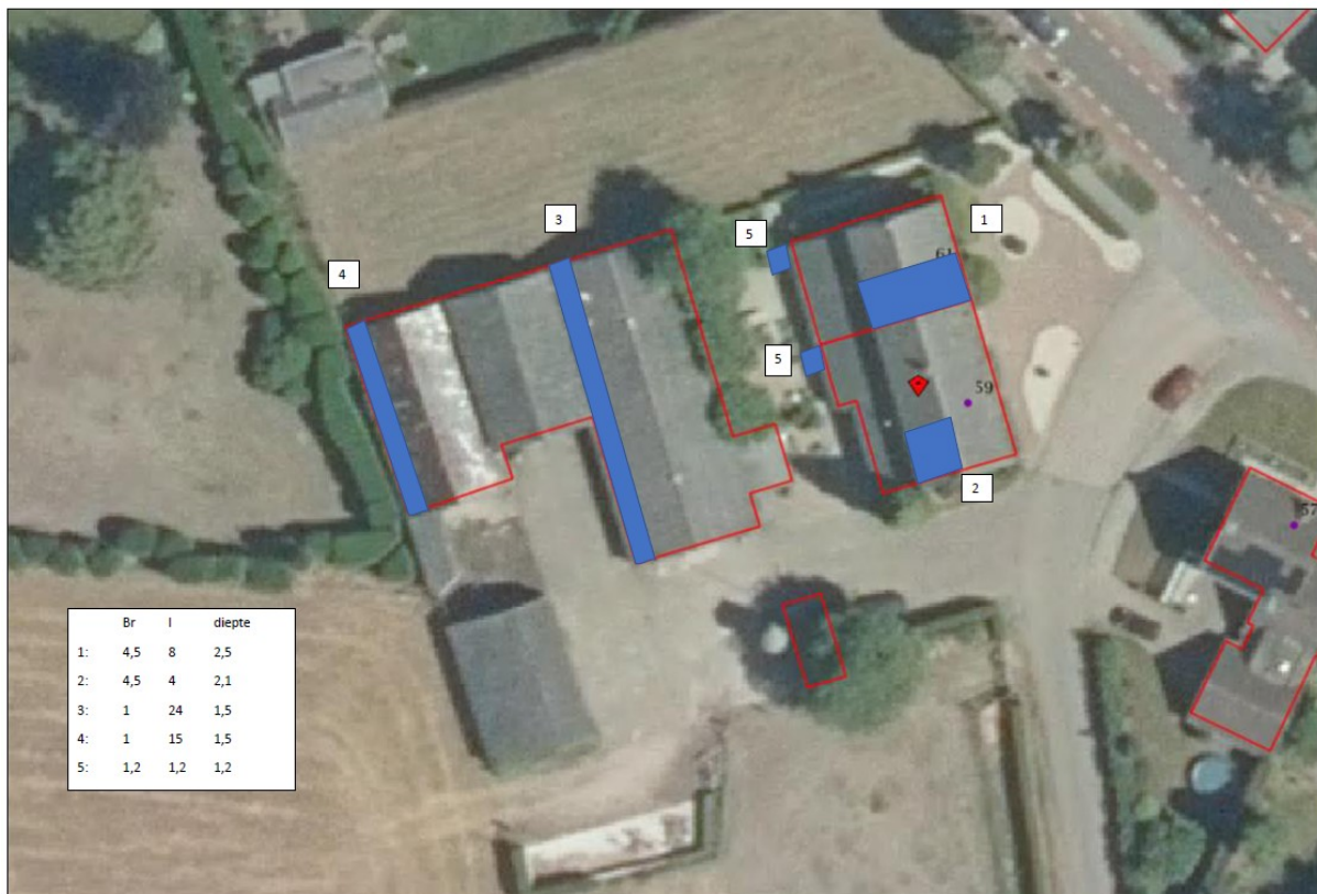
Figuur 19: In blauw de ligging van kelders, mestsleden en putten met de fundering van de bestaande gebouwen met de diepte hiervan in het kader binnen de foto. Gebouwen 3 en 4 en de langgevel boerderij zijn gebouwd op een fundering. Het gebouw tussen gebouw 3 en 4 alsmede het gebouw in het verlengde van gebouw 4 zijn gebouwd op poeren.
