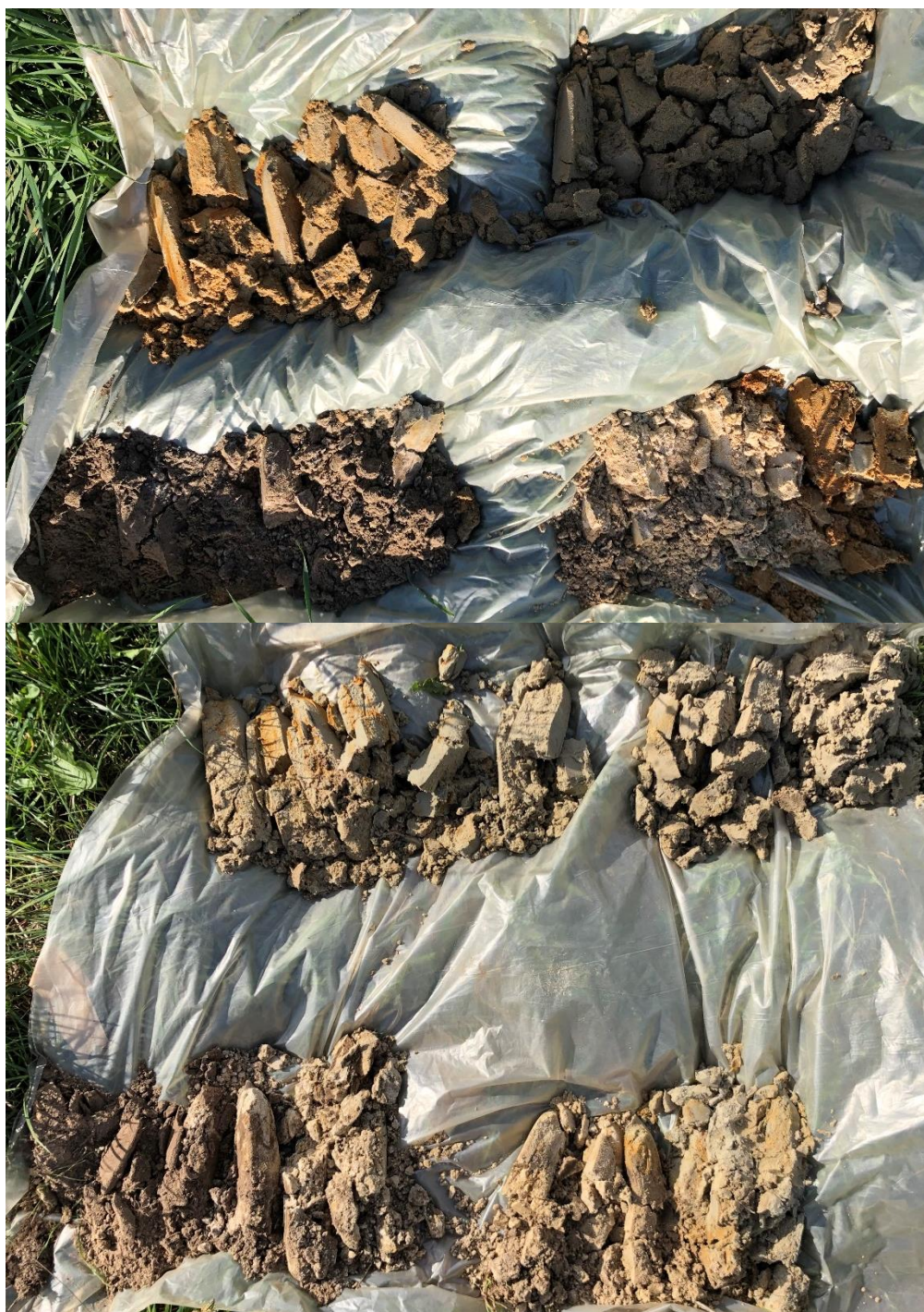
Afbeelding 3: Voorbeeld profielboring B (boven) en C (onder); leesrichting van linksonder naar rechtsboven
