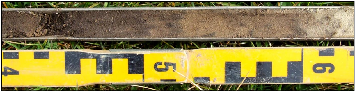
Figuur 15: Foto van een gedeelte van boring 1 met een zwak geroerde scherpe overgang van de Ap-horizont (links) naar de C-horizont (rechts) tussen 50 en 60 cm -mv. Er zijn enkele houtskoolspikkels zichtbaar in deze overgangszone.
