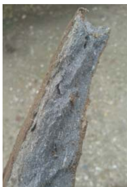
Afbeelding 2, 3 en 4: waargenomen stukken asbestverdacht plaatmateriaal ter plaatse van ABG3)
