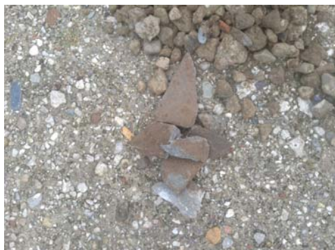
Afbeelding 2, 3 en 4: waargenomen stukken asbestverdacht plaatmateriaal ter plaatse van ABG3)
