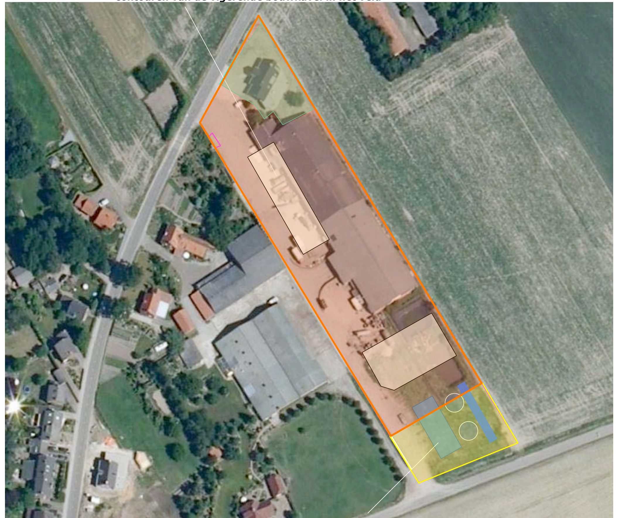
gewenste uitbreiding van de bouwkael voor de nieuwe bezinkvijver, waterzuivering, infiltratievijver
