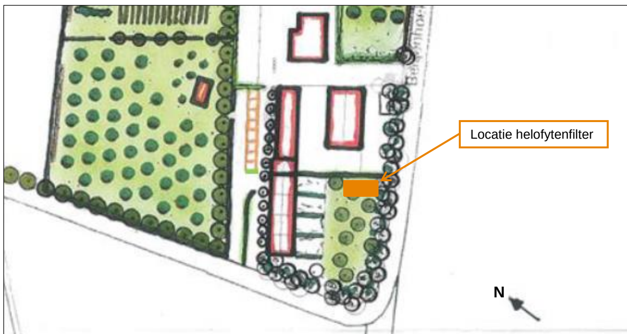
Figuur 10: locatie helofytenfilter van 80 \text{ m}^2
