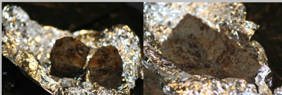
Foto van ijzeroxiden- en ijzersulfaatafzettingen in bodemprofielen uit Rode Waterparel
