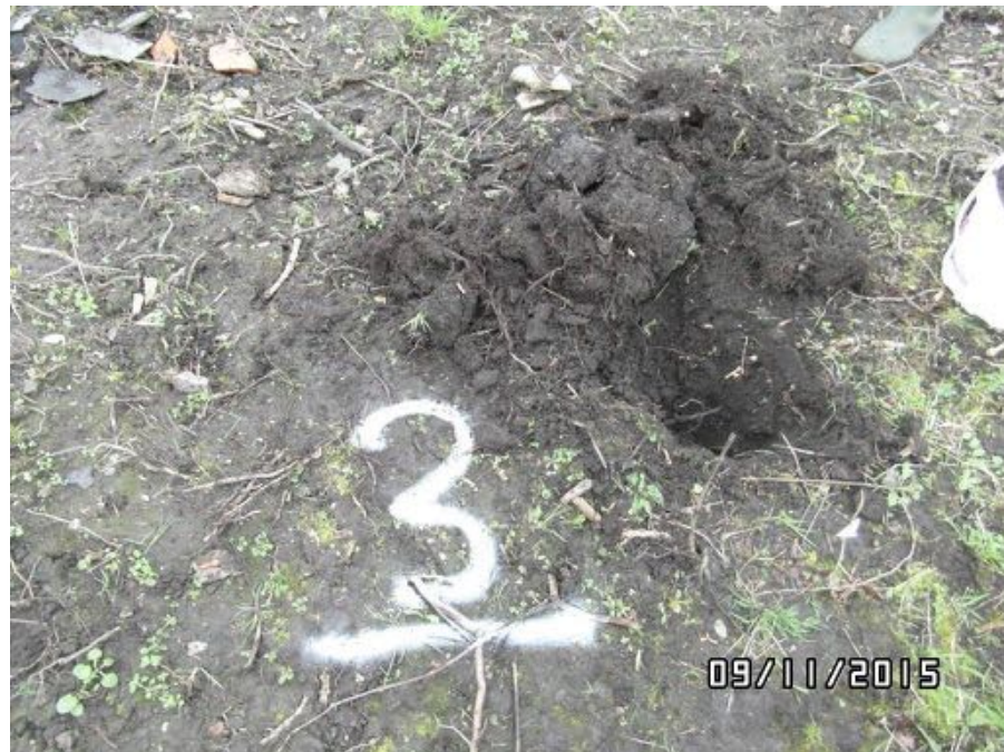
Plaats gat 3 voor indicatief onderzoek naar asbest in grond
