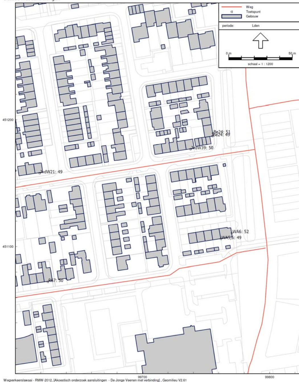
Figuur 3: Geluidsbelasting t.g.v. alle wegen samen, excl. aftrek ex art. 3.4 Rmg 2012, situatie met aansluitingen
