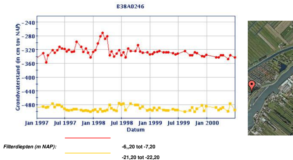
Afbeelding 6.2. Freatische grondwaterstanden en stijghoogte eerste watervoerend-pakket
