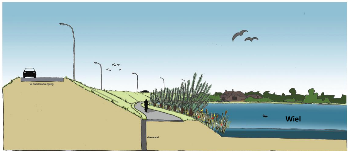
Moordrecht, dijksectie 1 damwand in binnenteen
