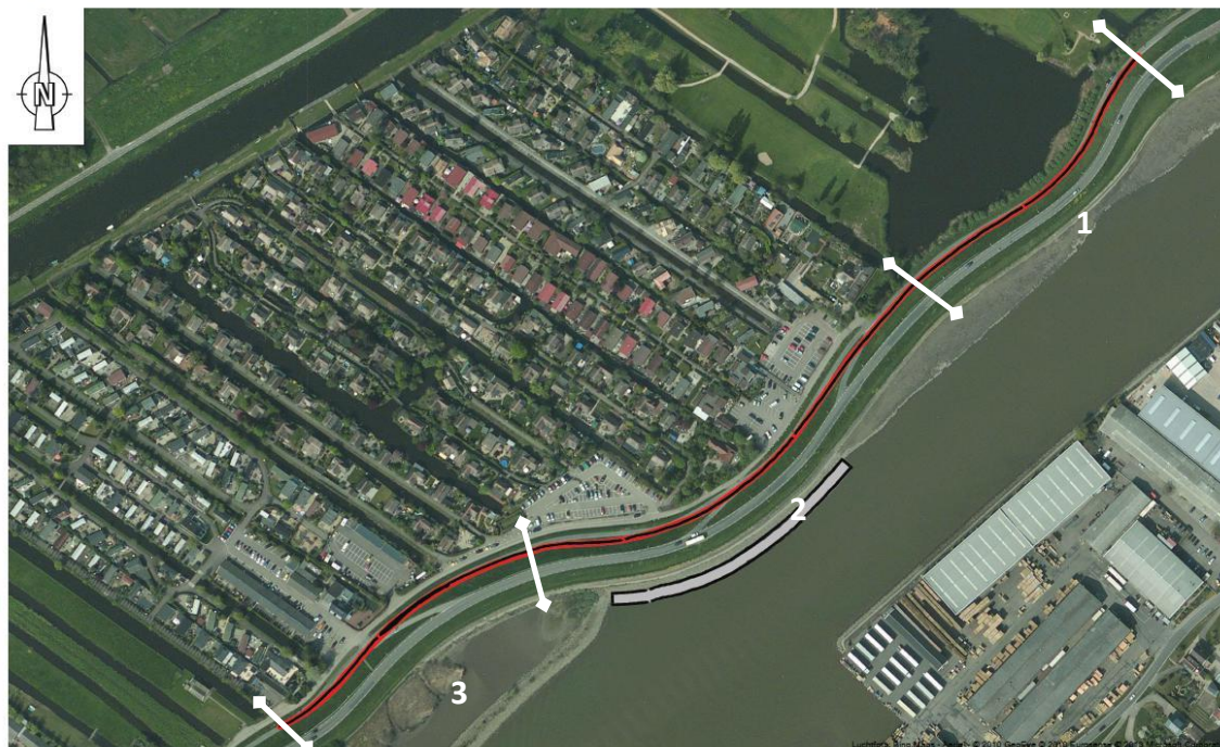
Figuur 3.3 Schetsontwerp voorkeuralternatief met sectieindeling
