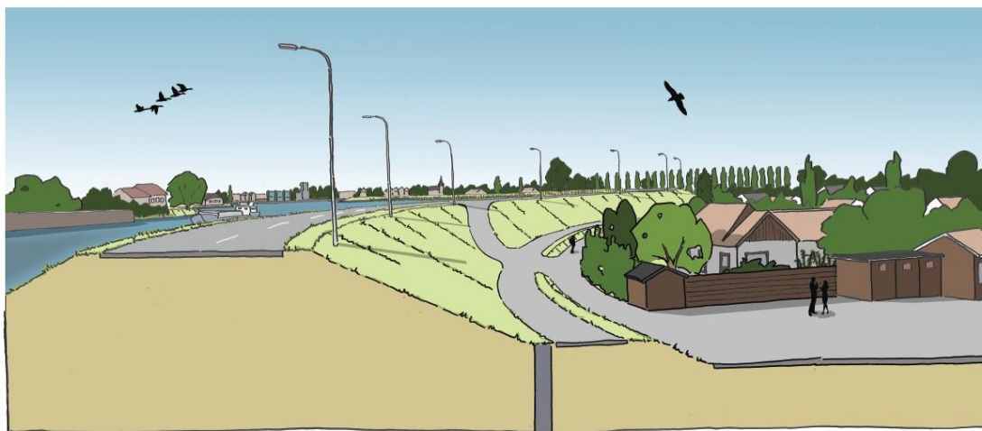
Moordrecht, dijksectie 2 en 3 damwand in binnenteen
