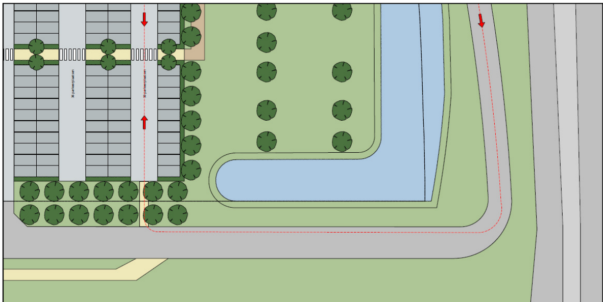
Figuur 4.1: Uitsnede inrichtingstekening plan, fietsontsluiting westzijde
