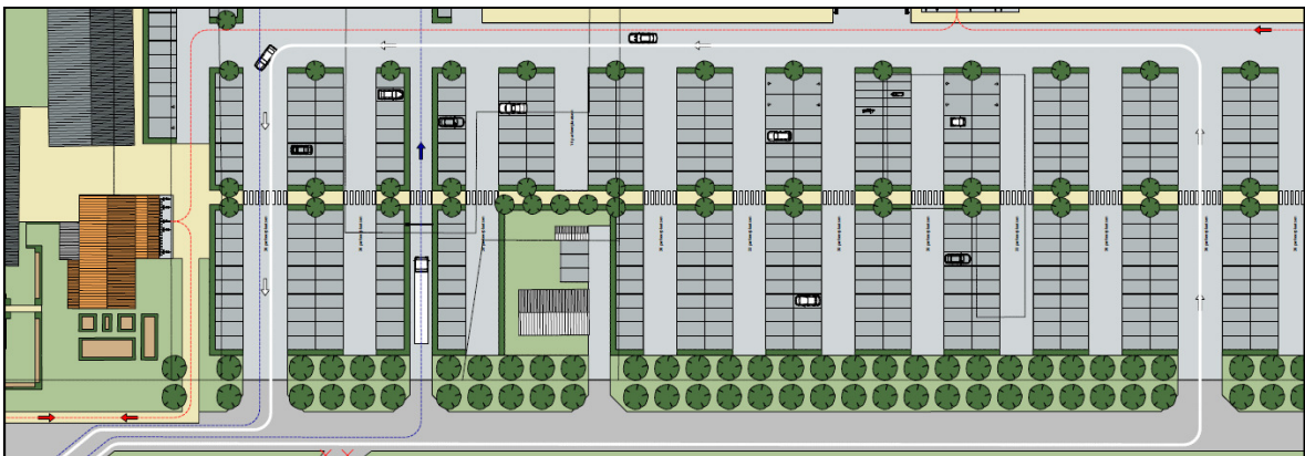
Figuur 4.5: Uitsnede inrichtingstekening plan, met routing autoverkeer (witte lijn)
