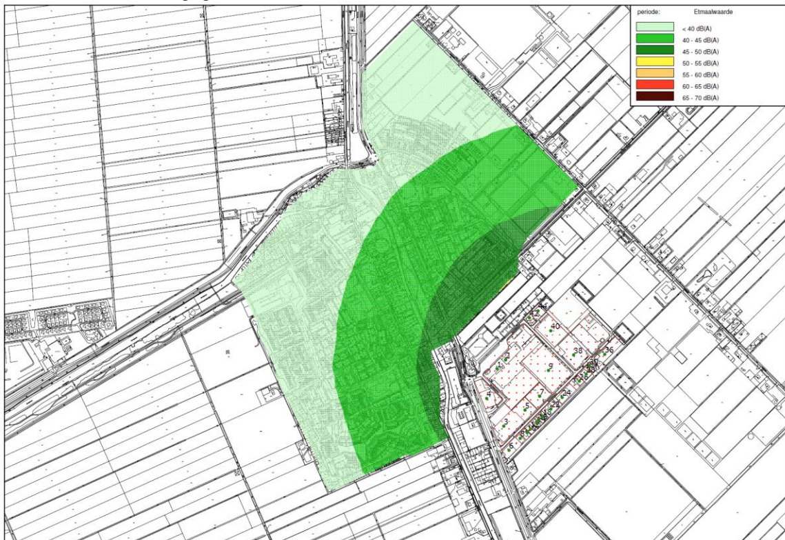
Figuur 3.1 Gecumuleerde geluidsbelasting bedrijven Nijverheidscentrum ter plaatse van het plangebied
