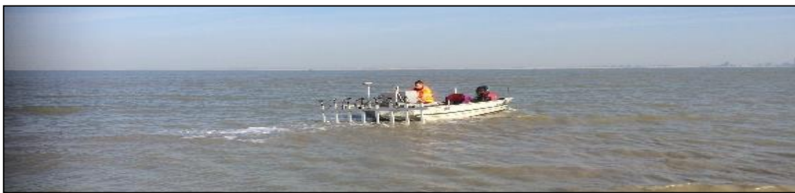
Uitvoeren passieve NON realtime waterbodemdetectie m.b.v. detectieboot.
