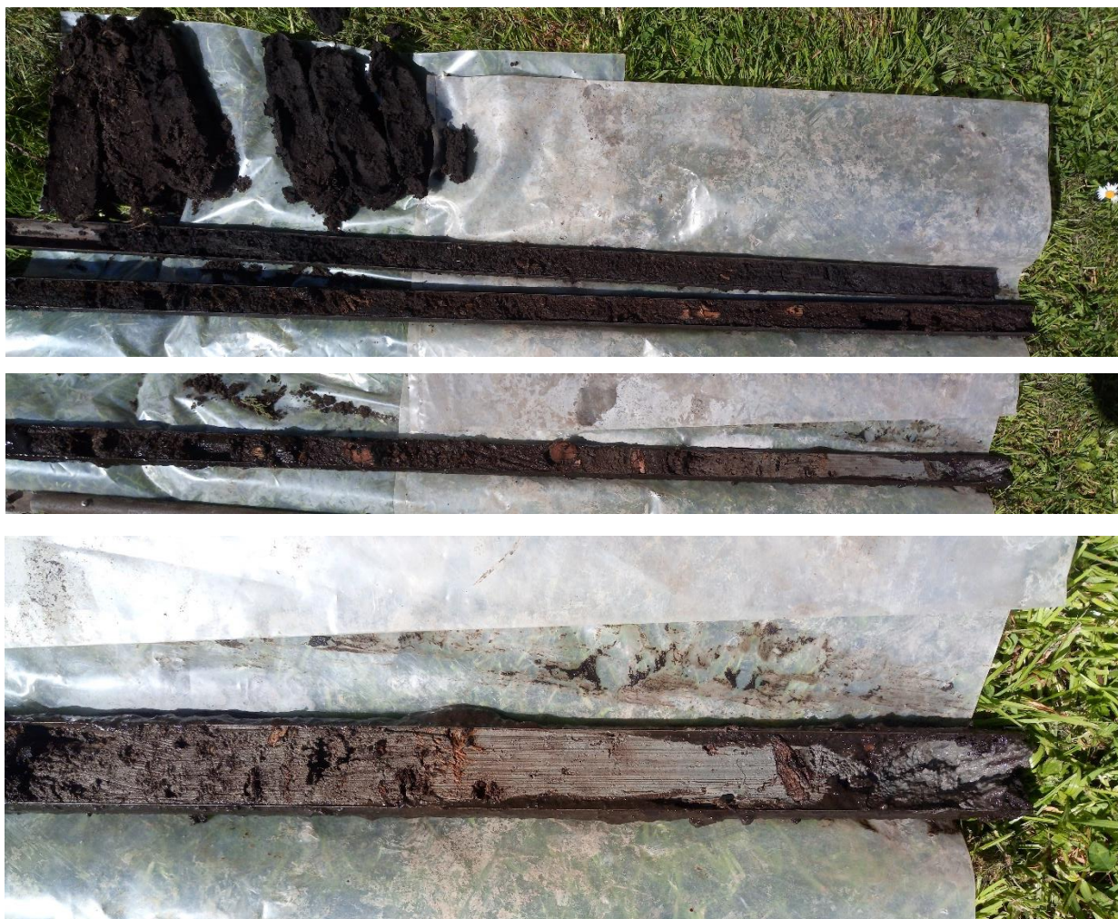
Boring 3: 0 – 350 cm -Mv. Onder: detail afzettingen Gouderak en/of Zuidplas stroomgordel, boring 3 (300-350 cm -Mv).
