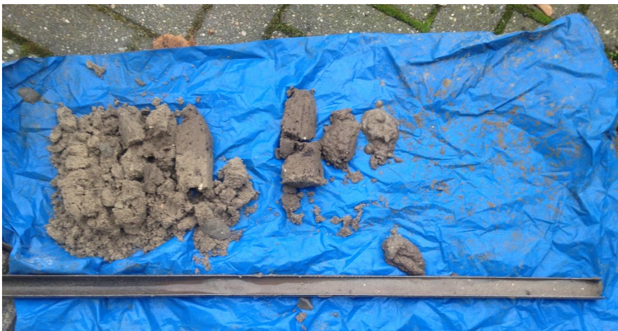
Boring 4: 0-150 cm -Mv. Dieper liggend materiaal is uit de guts gelopen onder invloed van grondwater.
