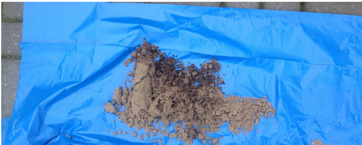
Boring 3: vierde poging, 0-30 cm -Mv. Gestaakt op zeer grof grind/puin.
