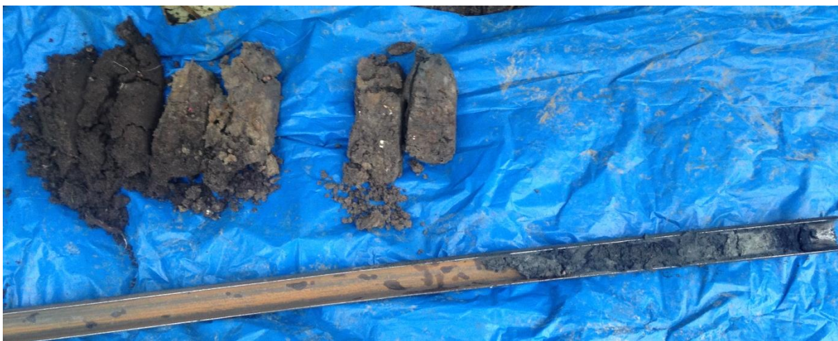
Boring 5: 0-100 cm. Vierde poging, gestaakt in puin/grind laag of op leidingen.
