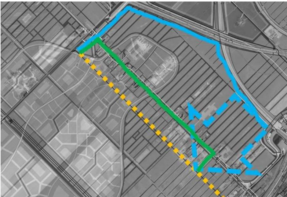
Figuur 5.1 Mogelijke omlegging gasleiding, oranje gestippeld is huidige tracé, in blauw en groen de mogelijke tracés voor de omlegging
