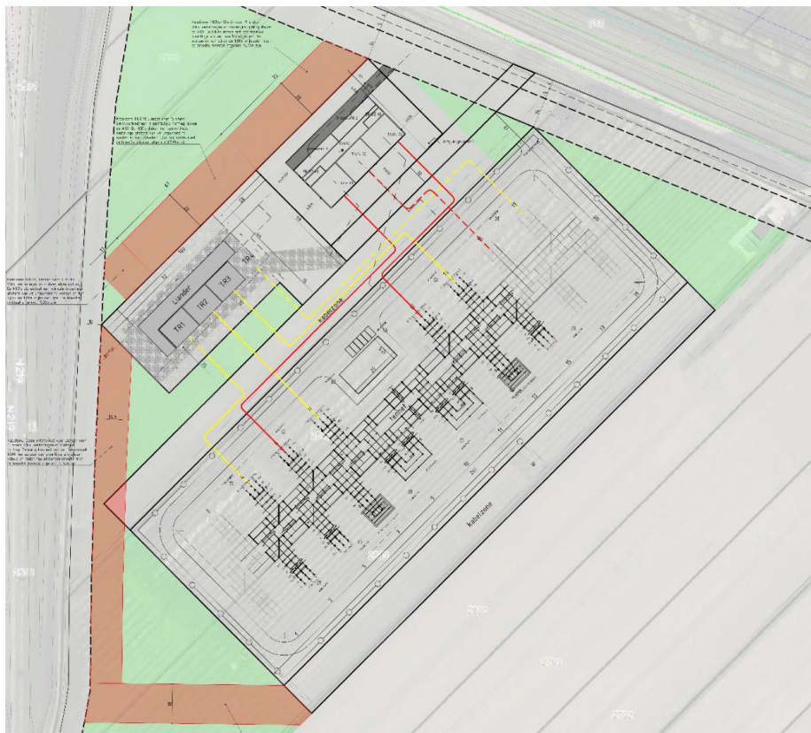
Figuur 2: Lay-out stationsontwerp en kabelloop eindsituatie onderstation Zevenhuizen/Zuidplaspolder (bron: Inrichting perceel – variant 6J.pdf)
