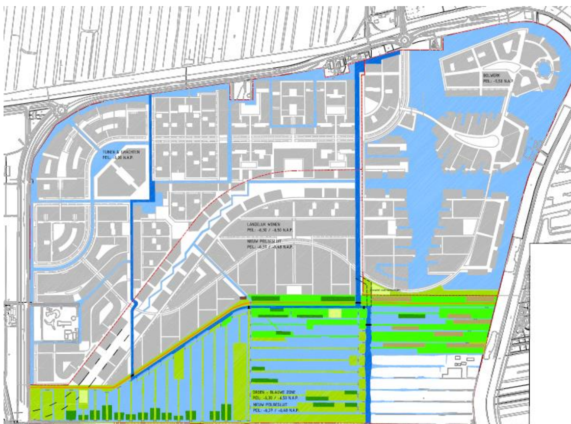
Afbeelding 1. Uitwerking waterhuishouding Westergouwe 2012 o.b.v. Addendum I (situatie zomerpeil)
