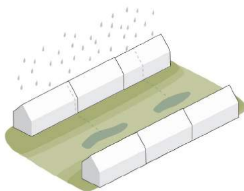
AFVOER HEMELWATER IN WADI
