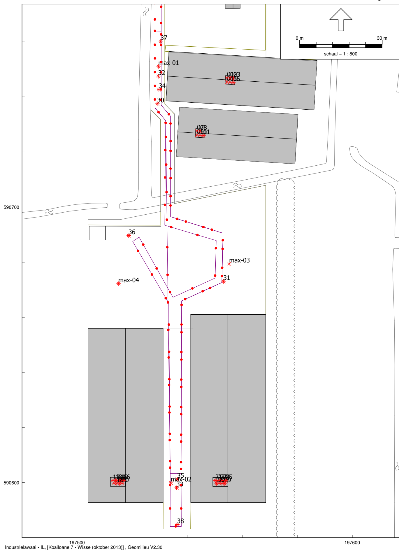
Detailoverzicht van het rekenmodel, met de ingevoerde geluidsbronnen
