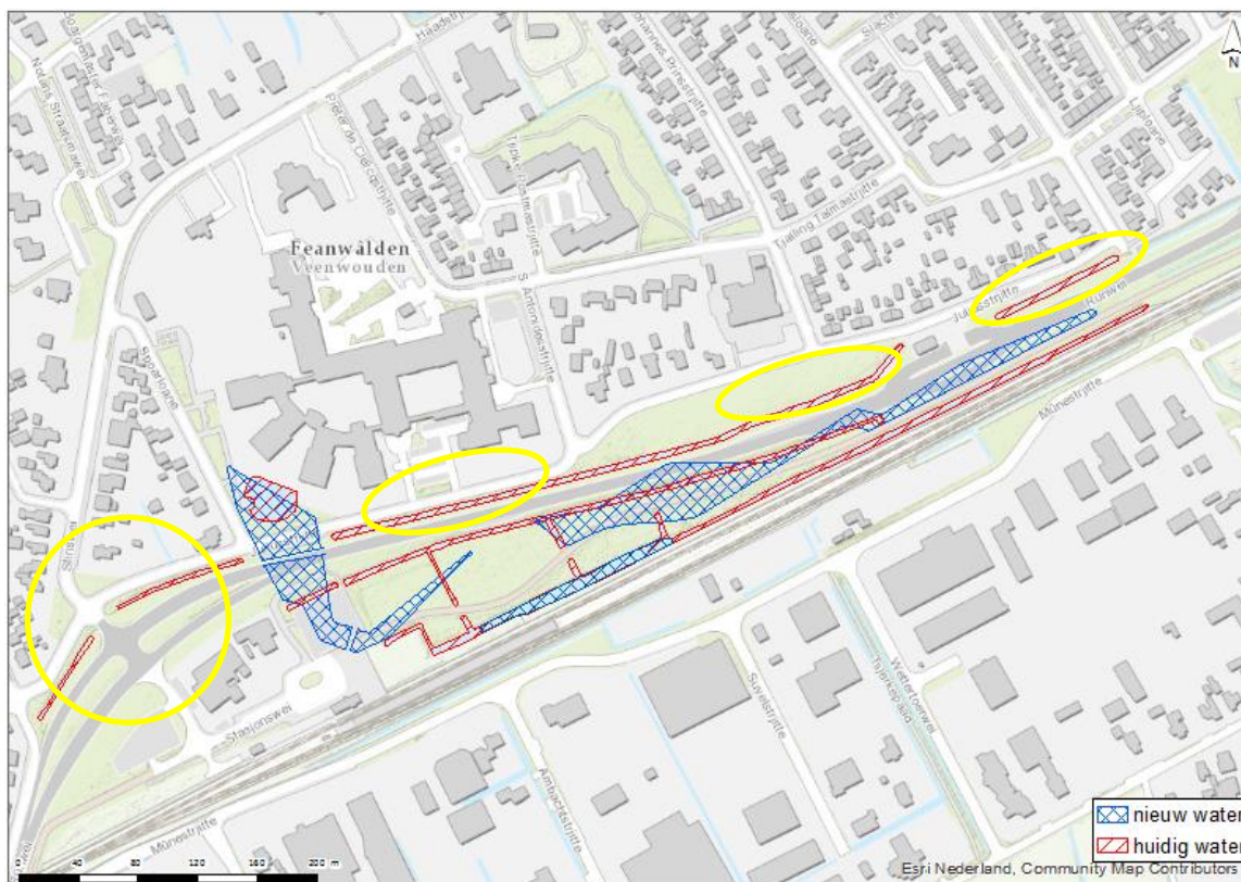
Afbeelding 4.8 plekken waar de opbolling van het grondwater kan toenemen
