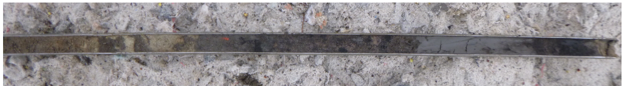
Figuur 6: Readtsjerk, Hjelburd 7: Het pakket vergraven/opgebracht zand en klei (links) zoals dit in de boringen 3, 4, 5 en 8 tot en met 11 is aangetroffen (in dit geval in boring 3) met rechts daarvan klei en veen (bruin) en geheel rechts de vernatte tot van het dekzand.
