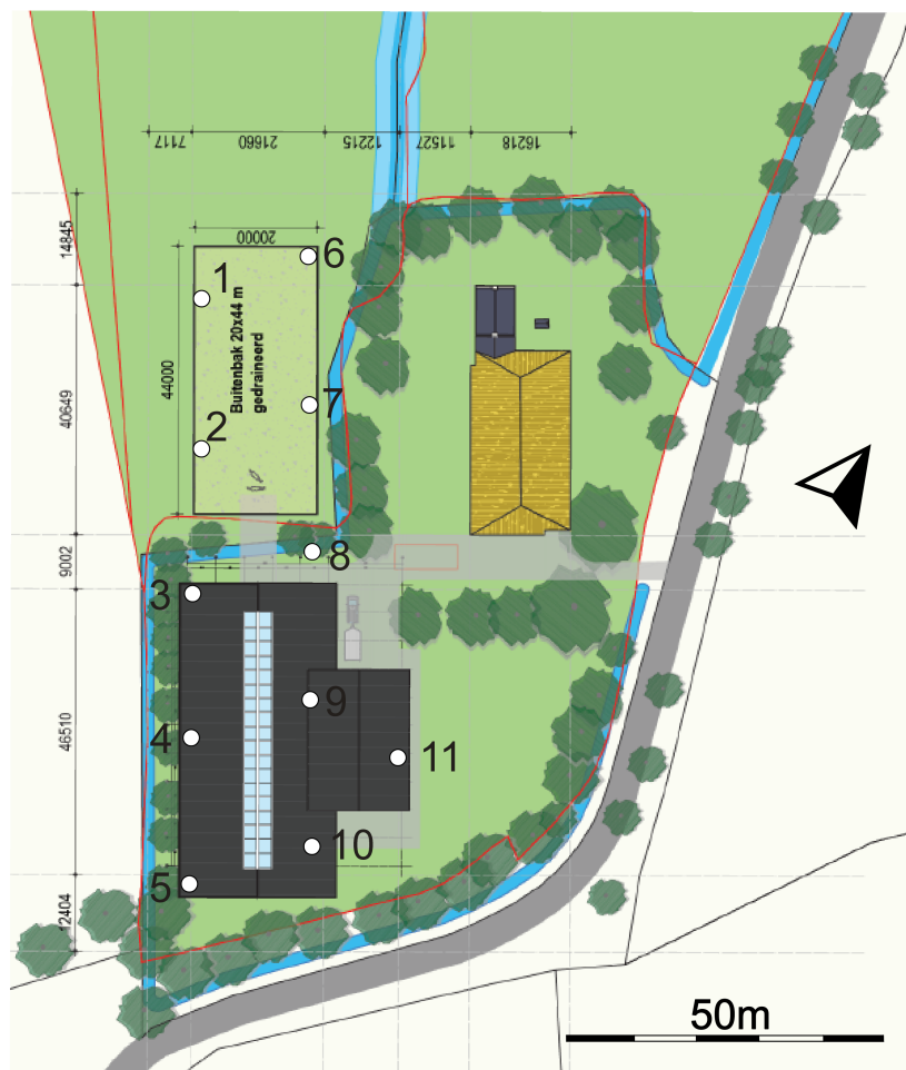
Figuur 5: Readtsjerk, Hjelburd 7: De boorpunten geprojecteerd op de plankaart. De genummerde punten zijn de locaties van de boringen. Bron: AdemaArchitecten
