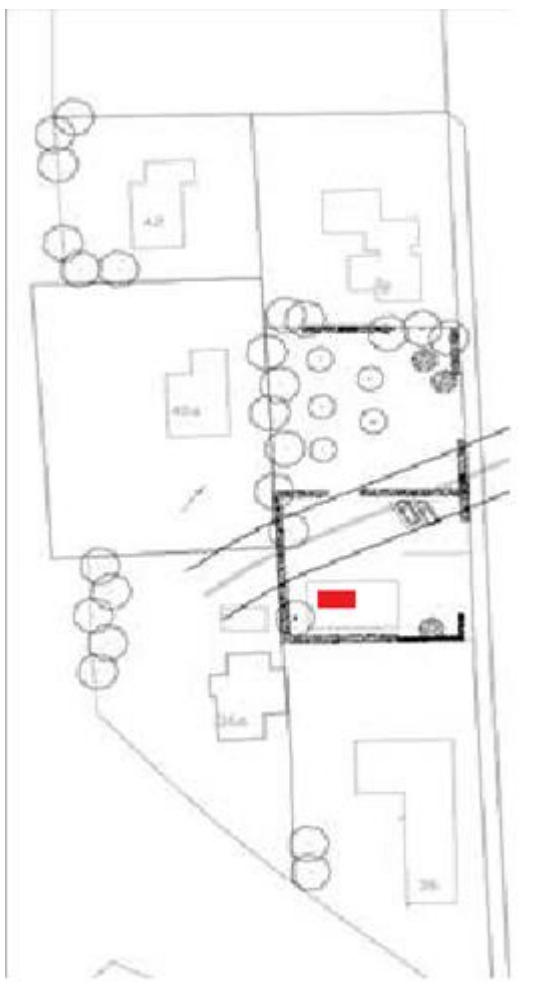
Figuur 4: Bouwblok woning t.o.v. buisleiding en belemmeringenstrook
