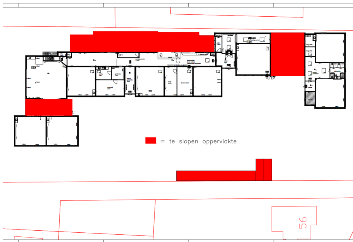
Figuur 2.10 Te slopen gedeeltes van het gebouw (bron: Rend)
