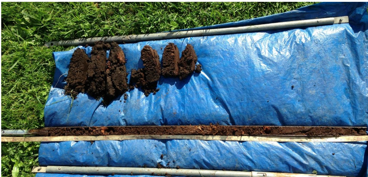
Boring 5: boring indicatief voor boringen 4 en 5. Grof puin in de toplaag tot 70 cm -Mv, gevolgd door houtveen en rietveen tot 200 cm -Mv.
