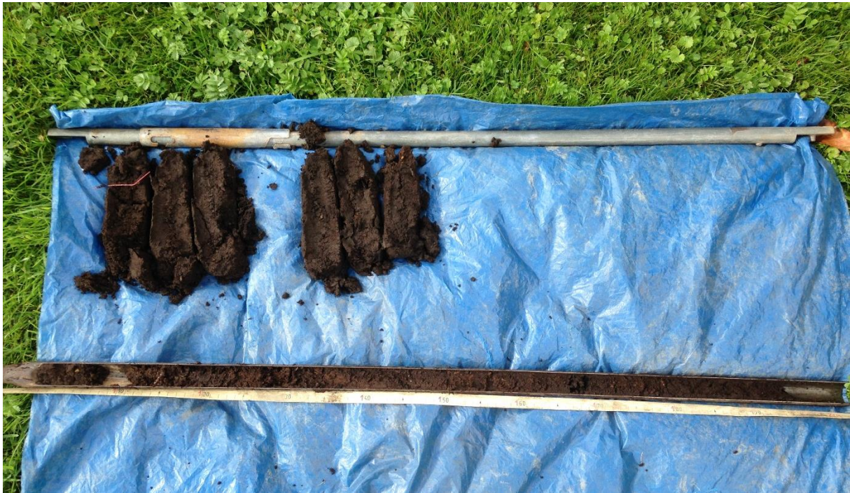
Boring 1: boring indicatief voor boringen 1 t/m 3. Klein puin in de toplaag tot 30 cm -Mv, gevolgd door houtveen en rietveen, tot 200 cm -Mv.
