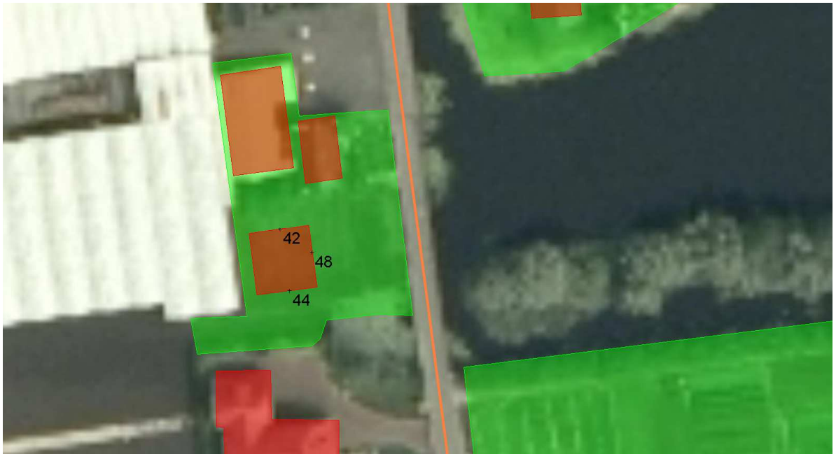
Figuur 2: geluidbelasting in dB, incl. aftrek, hoogste waarde per waarneempunt.
