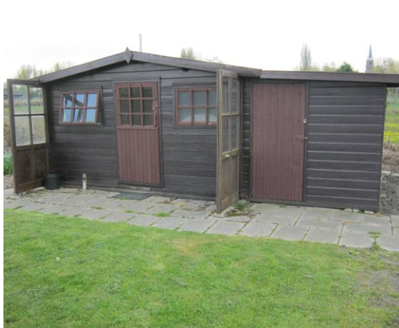
Bestaand schuurtje, zonder spouwmuur of dakisolatie (bron: initiatiefnemer, juli 2025)
